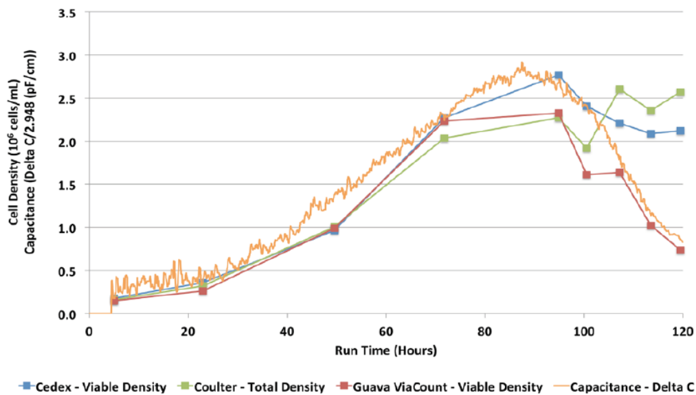
圖3. 比較Off-line, At-line和 In-line測量VCC的方法(經 University of Manitoba許可出版公開)
